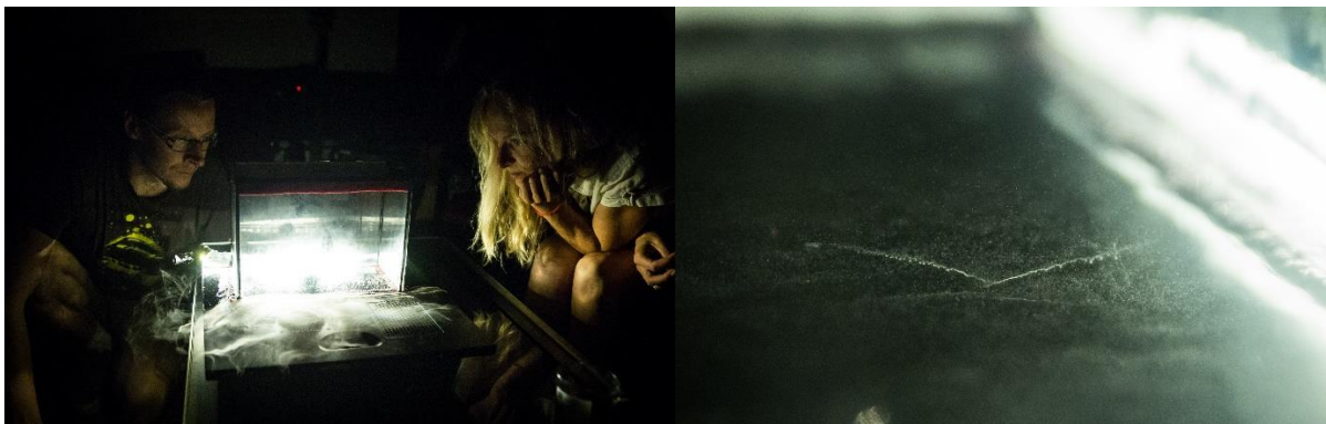
Obrázek 5, 6: Vlevo je dvojice pozorující částice v mlžné komoře. Vpravo vidíme nejspíše rozpad mionu. Foto: Pavel Váňa
